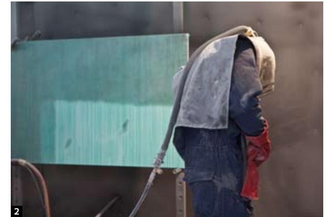
1. Phase de contrôle de la dorure dans l'atelier du verrier. 2. Dans son drôle de scaphandre, le sableur procède au sablage de toutes les pièces sur leur verso.
